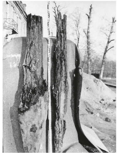
Verrottete Holzpfehle aus dem Fundament von 1719, Foto von 1968.
